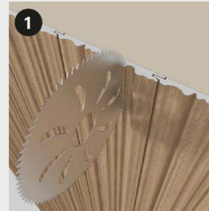
Le panneau endommagé doit être coupé en deux endroits comme indiqué.
