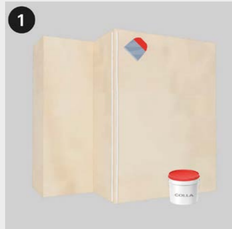
1 Appliquer la colle murale à partir des coins extérieurs du mur. Tragen Sie den Wandkleber an den äußeren Ecken der Wand auf.
