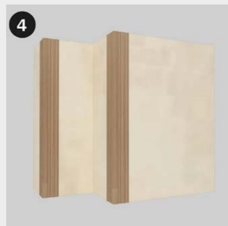
4 Collez le premier module à côté du profilé d'angle nouvellement installé, en appuyant légèrement pour le fixer. Kleben Sie das erste Modul neben das neu installierte Eckprofil und drücken Sie es leicht an, um es zu fixieren.
