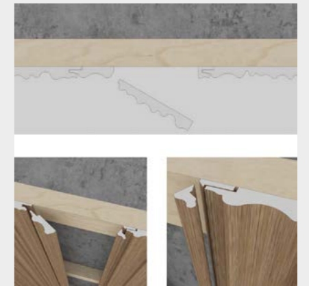
Retirer la partie centrale puis les deux parties latérales.
