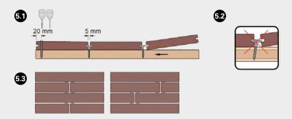
Les dalles doivent être fixées avec des vis à chaque extrémité des cales. Chaque extrémité des dalles doit être fixée à l'aide de deux vis. Si nécessaire, doublez la cale.
