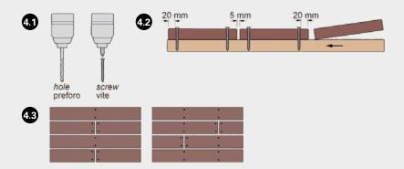
Les dalles doivent être fixées avec des vis à chaque extrémité des cales. Chaque extrémité des dalles doit être fixée à l'aide de deux vis. Si nécessaire, doublez la cale.
