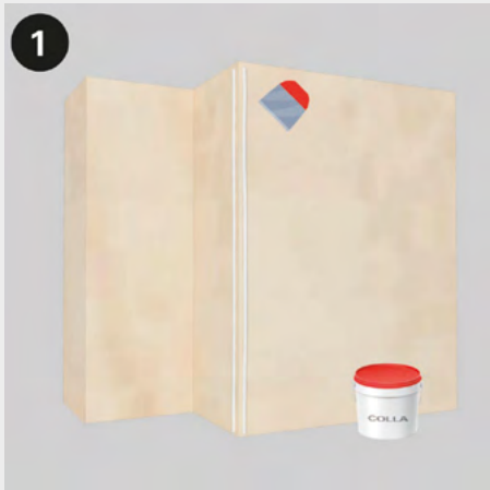
Appliquer la colle murale à partir des coins extérieurs du mur.
