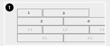
ÉTABLIR L'ÉCHELONNEMENT ET PRÉPARER LES MATÉRIAUX Chaque format de la collection Clap! doit être installé en effectuant une pose décalée des éléments. Il est nécessaire de décaler les dalles et les maxicarreaux, en effectuant une pose régulière et en les alternant avec une distance minimale de 30 cm. Outils nécessaires : dalles, sous-couche, maillet en caoutchouc, espaceurs et cale de frappe.
