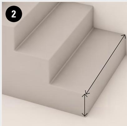
2 Messen Sie die Höhe und Länge der ersten Setzstufe der zu verkleidenden Stufe. Schneiden Sie eine Diele von Clap! so zu, dass es die Setzstufe bedeckt.
