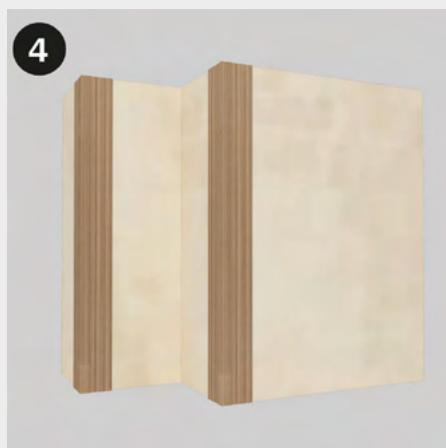
Kleben Sie das erste Modul neben das neu installierte Eckprofil und drücken Sie es leicht an, um es zu fixieren.
