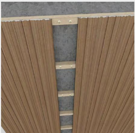
Tragen Sie den entsprechenden Kleber auf die horizontalen Keilen auf, um die neue Platte zu befestigen.
