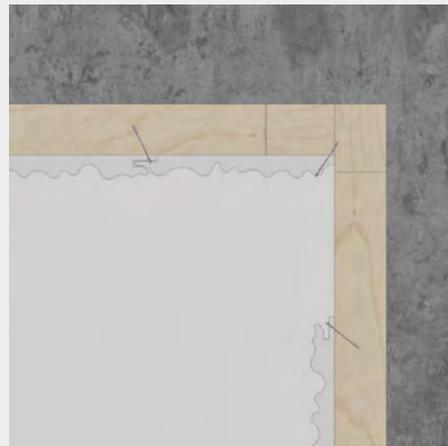
Montieren Sie die zugeschnittene Platte, indem Sie sie mit den entsprechenden Halterungen in einem 45°-Winkel an den Nägeln befestigen.
