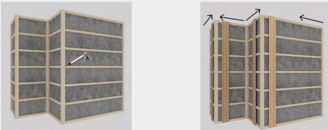
Tragen Sie Leim auf die vertikalen Keilen der äußeren Ecken auf, damit die beiden Anfangselemente besser gehalten werden.
