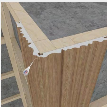
Nach dem Verkleben der Außenecken tragen Sie vorsichtig Kleber vom Typ Super Attack auf die Verbindungsstelle der beiden Profile auf. Wenn zu viel Kleber aufgetragen wird, entfernen Sie den Überschuss sofort mit einem sauberen, trockenem Tuch.
