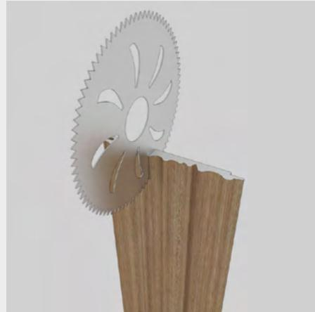
Abbildung 5 zeigt die innere Ecke im Detail. Messen Sie den verbleibenden Abstand zwischen der letzten Platte und der inneren Ecke, schneiden Sie das Paneel auf die gewünschte Größe zu, wobei Sie die Größe der Nut- und weiblichen Verbindungen berücksichtigen.
