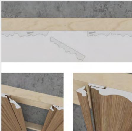
Entfernen Sie den mittleren Teil des zugeschnittenen Panels und die männlichen Verriegelungselemente.
