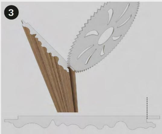
Schneiden Sie die neue Platte wie in der Abbildung gezeigt aus, wobei Sie die Lippe der "weiblichen" Verbindung entfernen.
