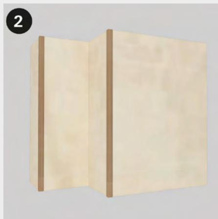
Kleben Sie die erste Ecke auf die äußeren Ecken und drücken Sie sie leicht an, um sie zu fixieren.
