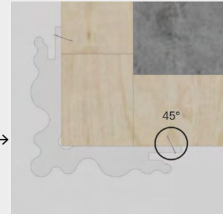
Installare il profilo angolare sull'angolo esterno e fissarlo con gli appositi groppini nell'incastrì femmina con una inclinazione di 45°.
