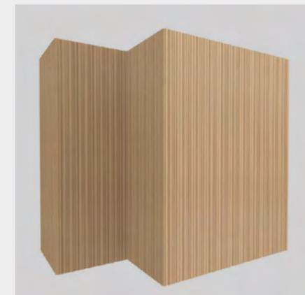
Sull'altro lato misurare la distanza tra l'angolo interno e l'ultimo pannello e tagliare il pannello secondo la misura ottenuta. Posizionare il pannello tagliato dopo aver applicato la colla specifica sui magatelli orizzontali.
