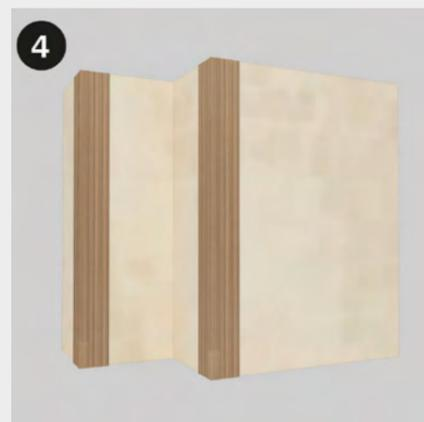
4 Incollare il primo modulo adiacente al profilo angolare appena installato premendo leggermente per fissarlo in posizione.
