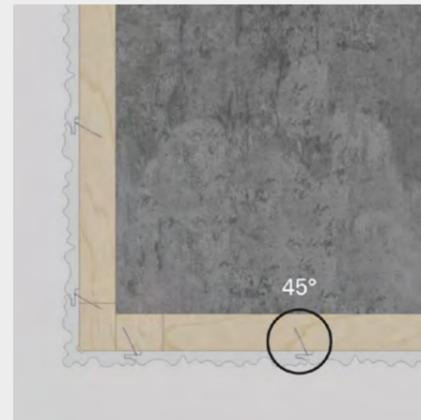
Dettagli del fissaggio dei pannelli alla sottostruttura, i groppini hanno una inclinazione di 45°
