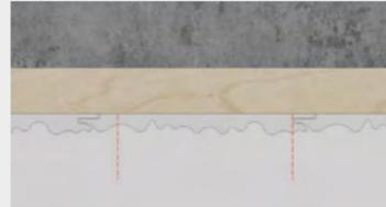
Il pannello da sostituire deve essere tagliato in due punti, come mostrato dalla figura centrale. Attenzione a non tagliare i magatelli della sottostruttura.
