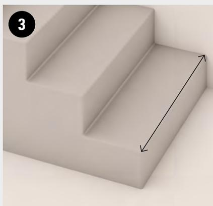
Mesurez la largeur de l'échelle et coupez le profilé Clap!Step en fonction de la mesure obtenue.
