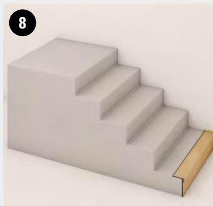
Procéder en veillant à toujours laisser 6 mm d'air sur les bords de l'escalier, puis coller le produit Clap!Step et compléter la marche en posant et collant la garniture de marche.
