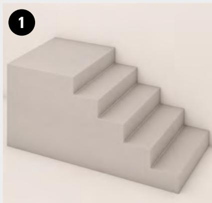
Vérifier les marches à revêtir ; leur surface doit être lisse, plane, sèche et dépeussière.
