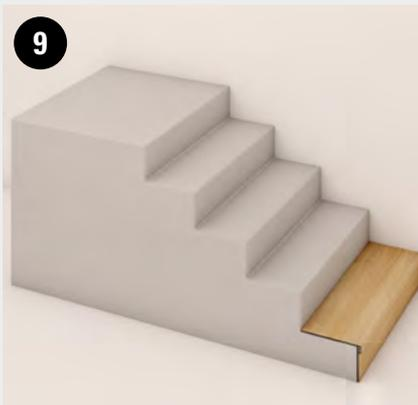
Vervollständigen Sie den Schritt, indem Sie die Trittstufenverkleidung anbringen und aufkleben.
