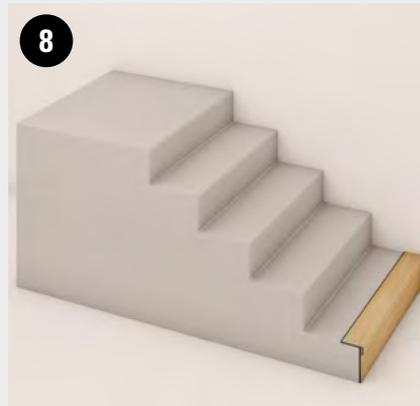
Achten Sie darauf, dass Sie entlang der Treppenkanten immer 6 mm Luft lassen, kleben Sie dann das Clap!Step-Produkt auf und vervollständigen Sie die Stufe, indem Sie die Trittstufenverkleidung anbringen und kleben.
