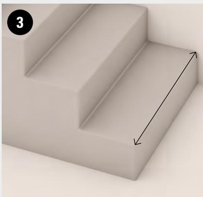
3 Messen Sie die Breite der Leiter und schneiden Sie das Clap!Step-Profil entsprechend dem ermittelten Maß zu.
