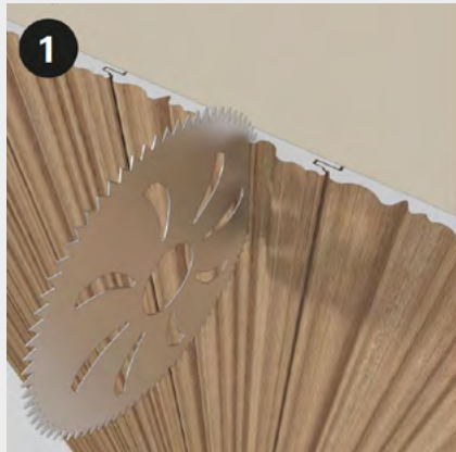
Il pannello danneggiato deve essere tagliato in due punti come mostrato in figura.
