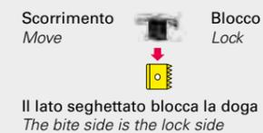
**Nota:** Ogni doga può essere bloccata con la clip di bloccaggio in un solo punto. Le clip di montaggio vanno tutte posate dallo stesso verso per tutta la pavimentazione
