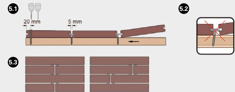
Die Dielen müssen mit Schrauben an jedem Keil befestigt werden. Jedes Ende der Dielen muss mit zwei Schrauben befestigt werden. Falls erforderlich, verdoppeln Sie die Keilen.
