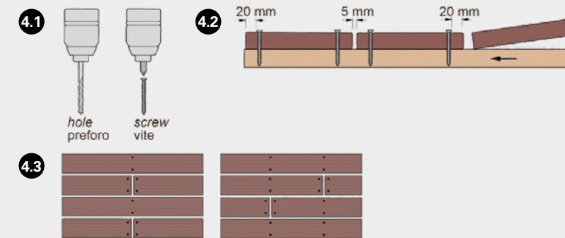
Die Dielen müssen mit Schrauben an jedem Keil befestigt werden. Jedes Ende der Dielen muss mit zwei Schrauben befestigt werden. Falls erforderlich, verdoppeln Sie die Keilen.
